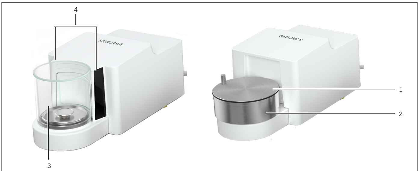
Abb. 2: Mikrowaage mit motorischem Glas-Windschutz und Filter-Mikrowaage mit manuellem Metallring-Windschutz (Beispiel)
