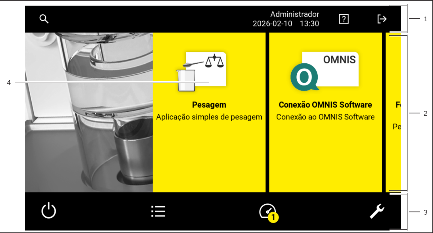
Fig. 5: Elementos Operacionais no Menu Principal (Exemplo)
