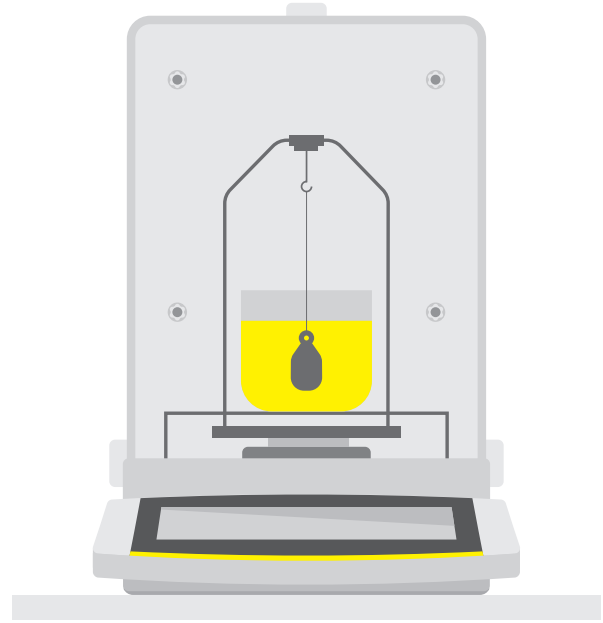
Abbildung 17: Bestimmung der Flüssigkeitsdichte nach der Auftriebsmethode
